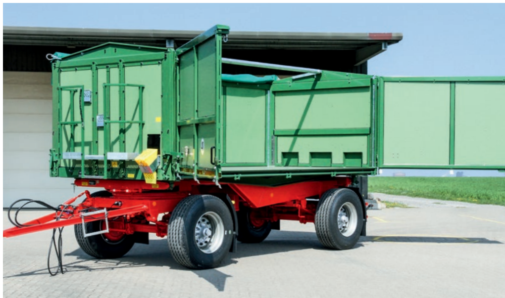
Ein- oder beidseitige Öffnung der Portaltüren, mit Arretierung durch Verriegelungshebel und Türfeststellern
